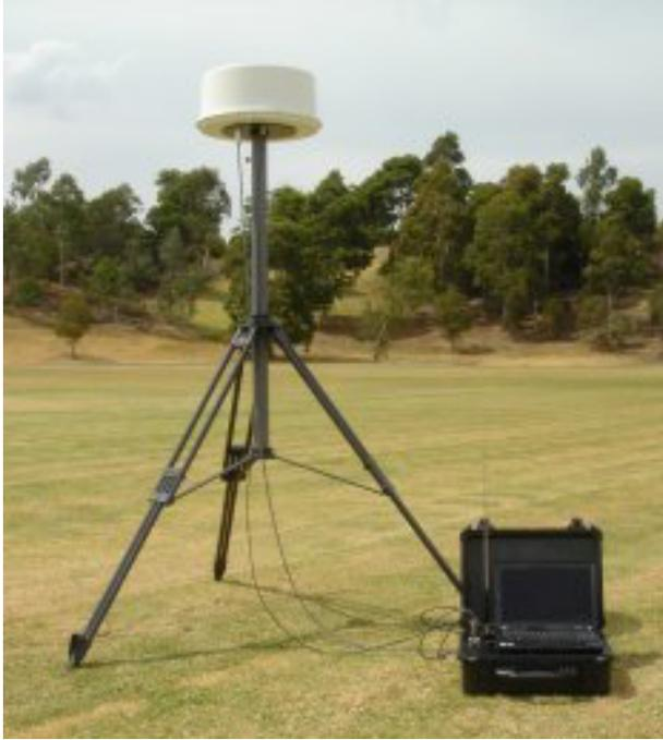
WD-3300 测向系统采用成熟的伪多普勒和沃森-瓦特方法，结合统计信号处理，为政府、军队、执法和工业应用提供经济有效的高精度测向解决方案。
